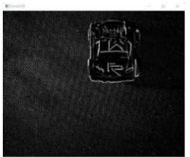
Fig. 6 Edge Detection using Prewitt Operator
